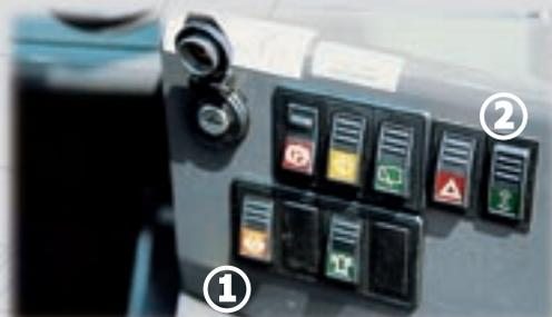
② - Il sollevamento elettro-idraulico del posto guida (standard), consente un facile accesso al motore per le operazioni di manutenzione riducendo i tempi di intervento.
