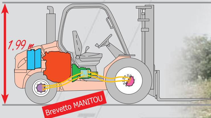
Le **4 ruote motrici** consentono al carrello MH una grande capacità di trazione per la movimentazione anche sui terreni accidentati.
